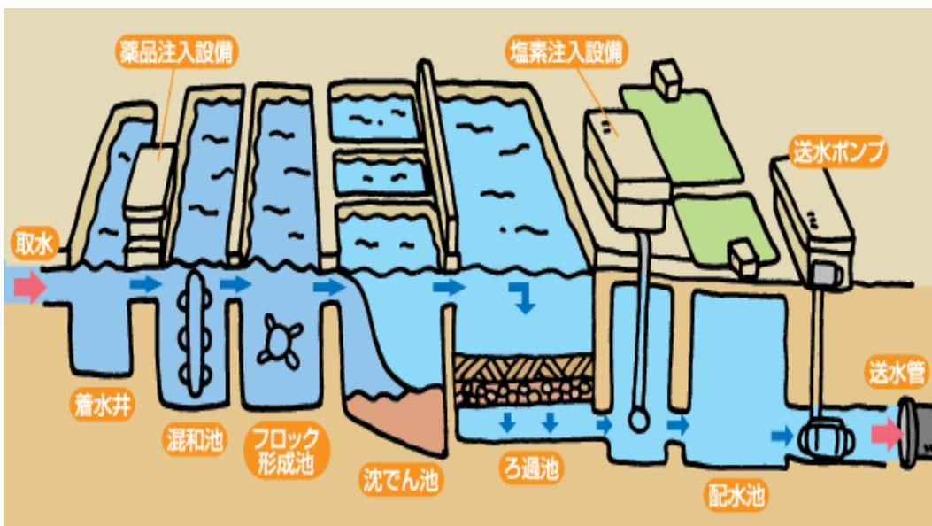
この方式は、汚れが激しい水に対してもそれなりに対応することができ、また狭い面積で時間当たりの浄水能力が高いため、大規模都市での浄水に適していますが、原水の汚れが激しい地域では、どうしても凝集剤の使用量が多くなり、水道水の中に「アルミニウム」が残留します。
